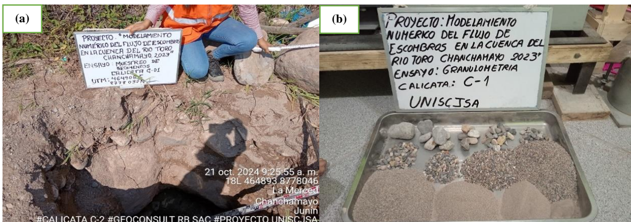
Nota. (a, b y c) Extracción de muestras para los ensayos de caracterización
