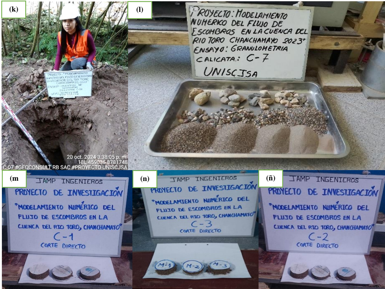
Nota. (a, b, c, d, e, f, g, h, i, j, k, l) Excavación de calicatas y ensayo de análisis granulométrico, (m, n, ñ) Ensayos de corte directo.
