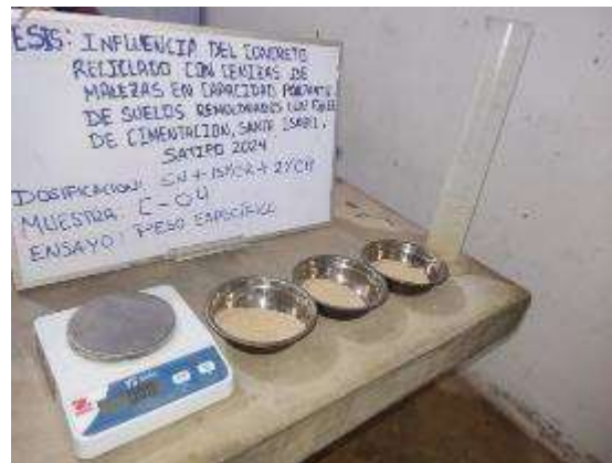
Foto 6: Ensayo de peso específico de cada muestra.
