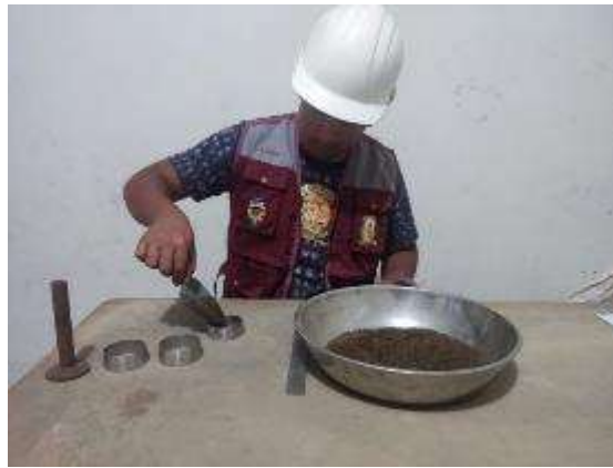
Foto 8: Preparación de especímenes para el ensayo corte directo.
