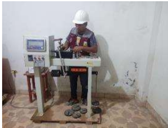
Foto 9: Instalación del equipo para ensayo corte directo.
