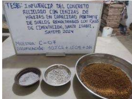
Foto 10: Dosificación de concreto reciclado, ceniza de malezas y suelo natural.
