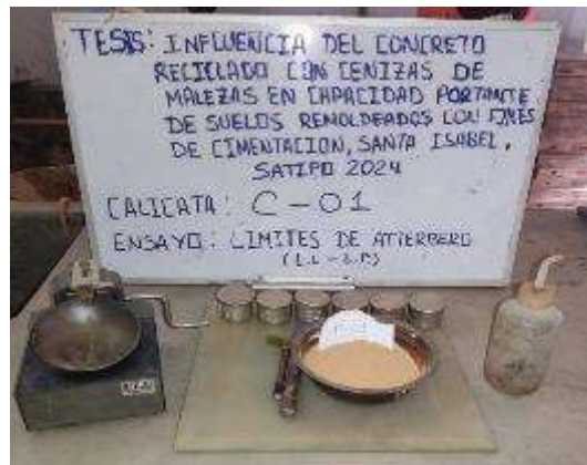
Foto 5: Ensayo de límite de Atterberg (Limite plástico y líquido).
