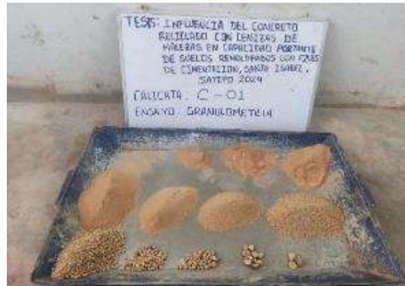
Foto 4: Ensayo de Granulometría del suelo.
