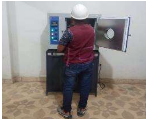
Foto 2: Secado de muestras en el horno.
