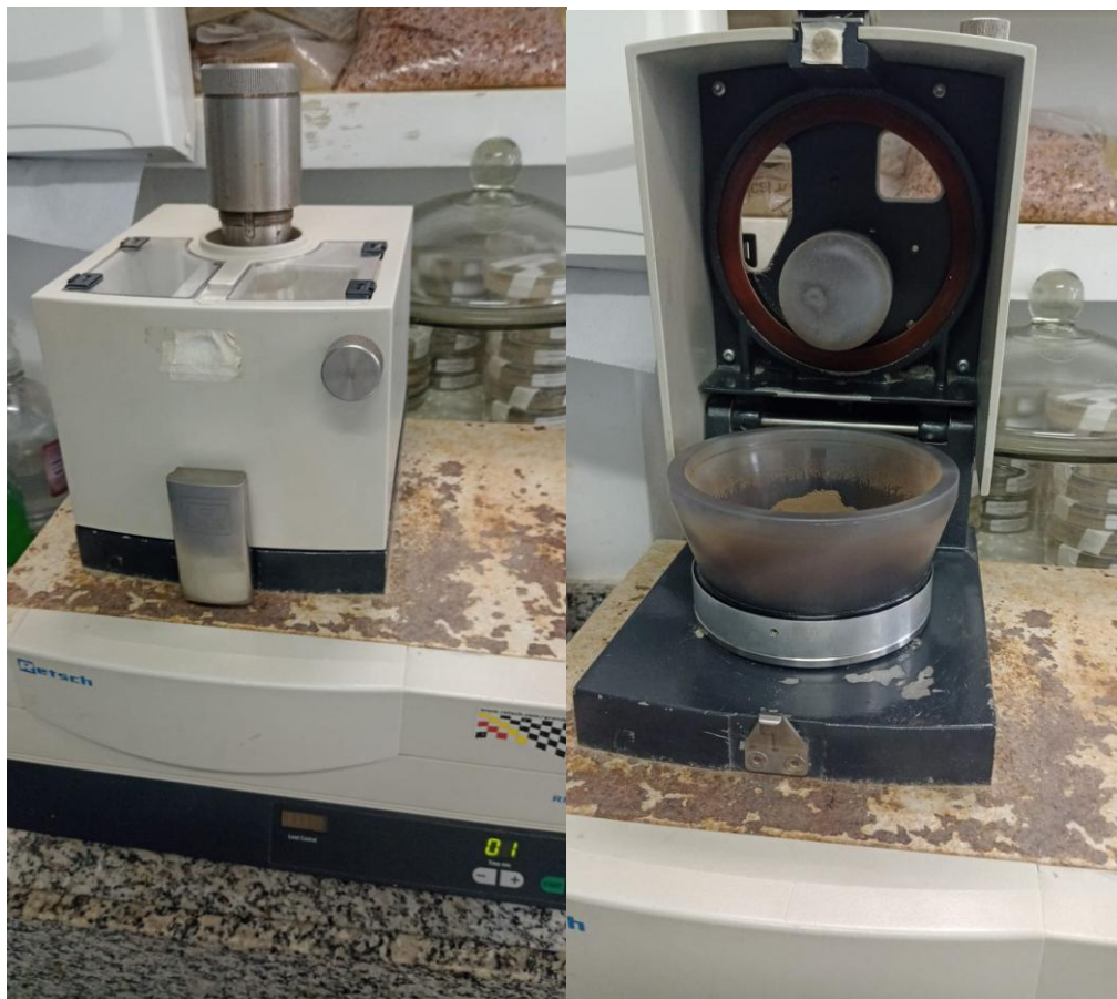
Figura 37 Manejo del molino de bolas para la pulverización de las muestras
