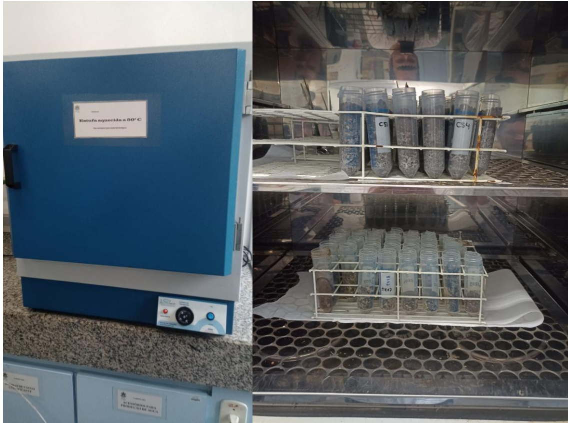
Figura 36 Las muestras son colocadas en la estufa para ser deshidratadas
