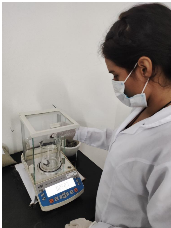
Figura 31 Pesaje de las muestras (5 g) que serán instalas en los sitios de muestreo
