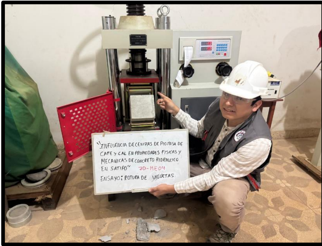
Foto 15: Rotura de vigueta de concreto.
