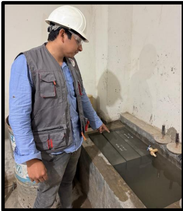
Foto 12: Curado de probetas y viguetas de concreto.
