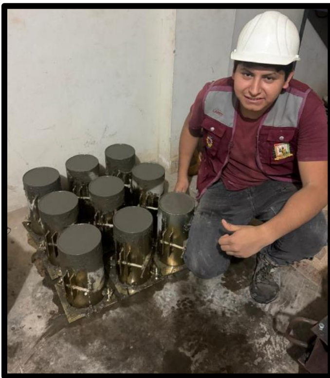
Foto 10: Realización de las probetas de concreto.
