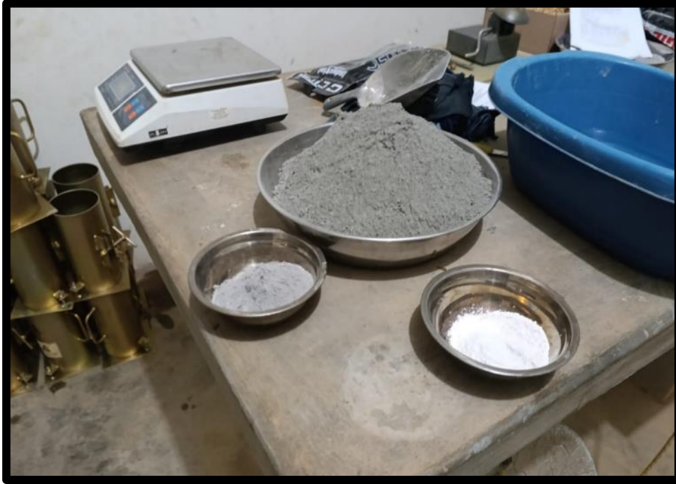
Foto 7: Dosificación de cemento, cenizas de biomasa de café y cal.
