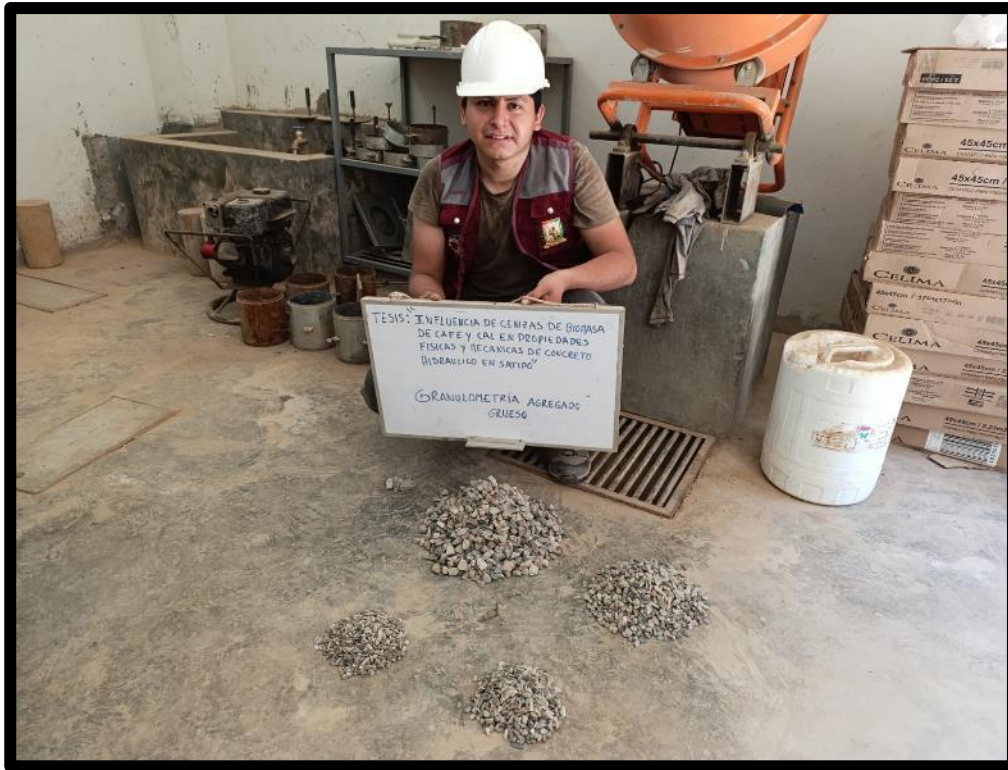
Foto 5: Granulometría de agregado grueso (piedra chancada)
