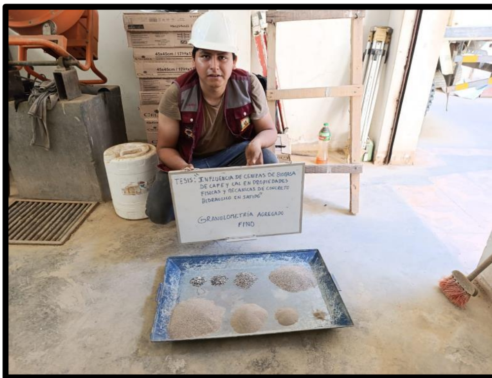
Foto 4: Granulometría de agregado fino (arena gruesa)
