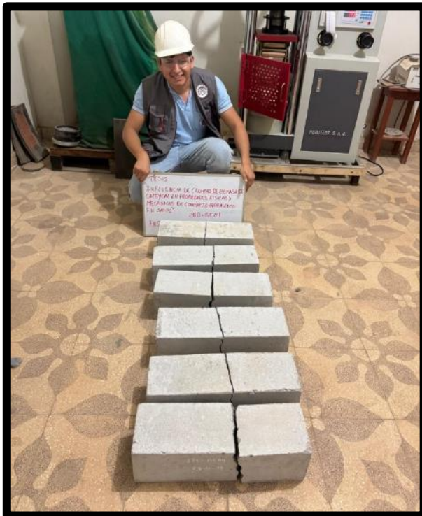
Foto 16: Rotura de vigueta de concreto.
