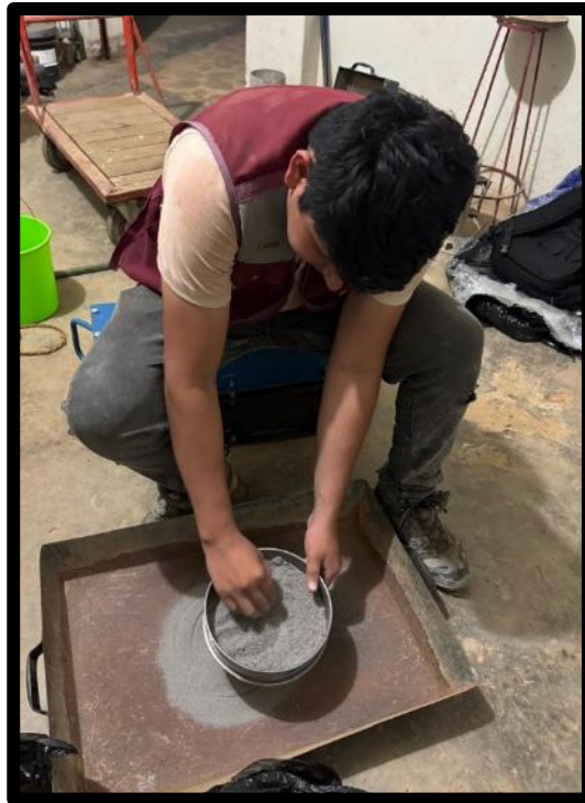
Foto 3: Tamizado de la cenizas de biomasa de café por la malla #200
