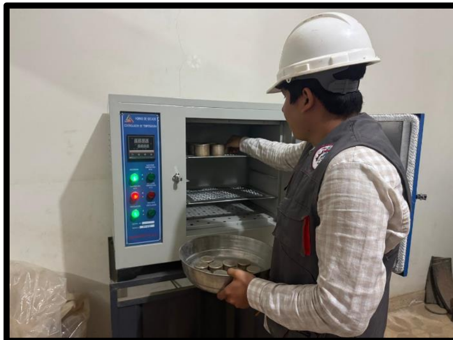
Foto 6: Secado de muestras en horno eléctrico, para calcular el contenido de humedad
