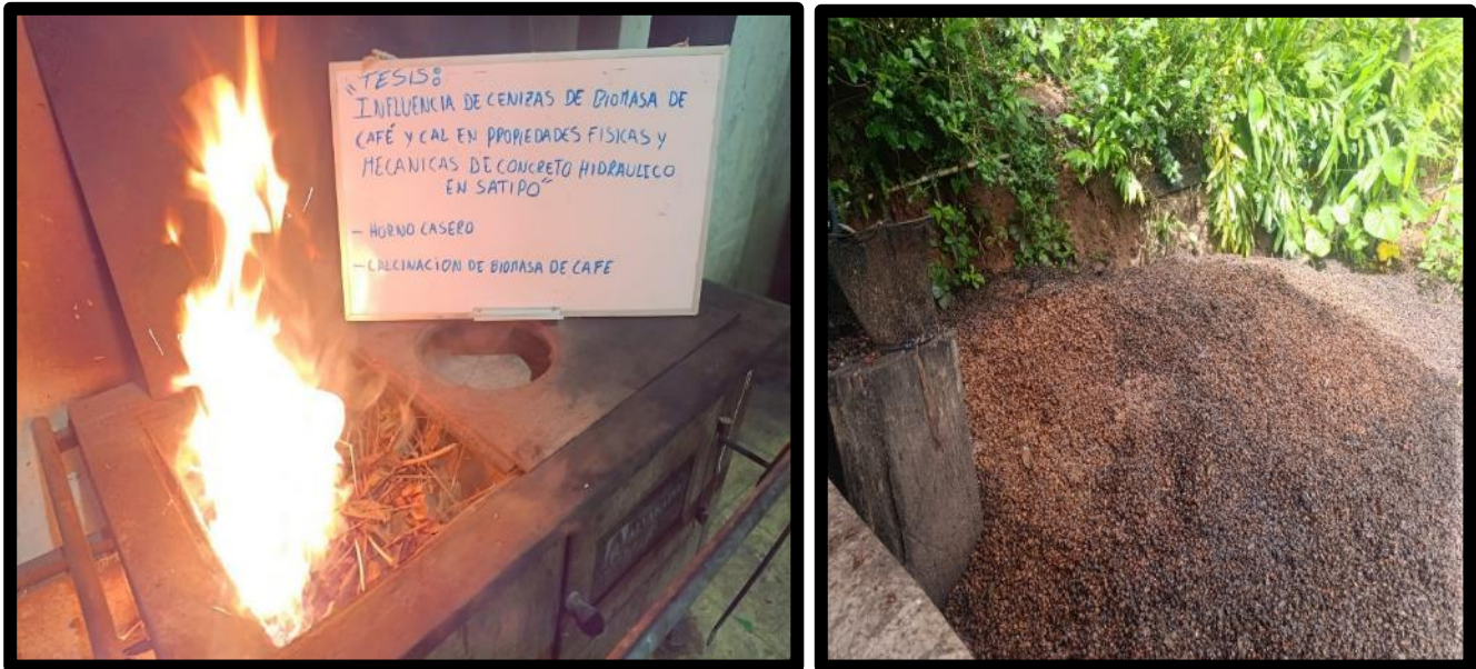
Foto 1: Extracción y calcinado de la biomasa de café
