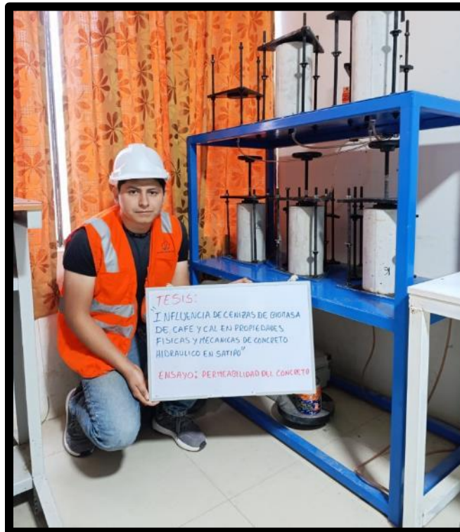
Foto 14: Ensayo a la permeabilidad del concreto con el equipo de transductor de presión.
