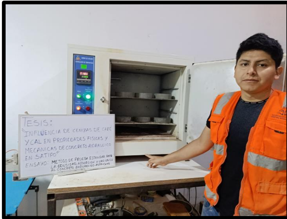
Foto 13: secado al horno los discos de concreto por no menos de 24 horas.
