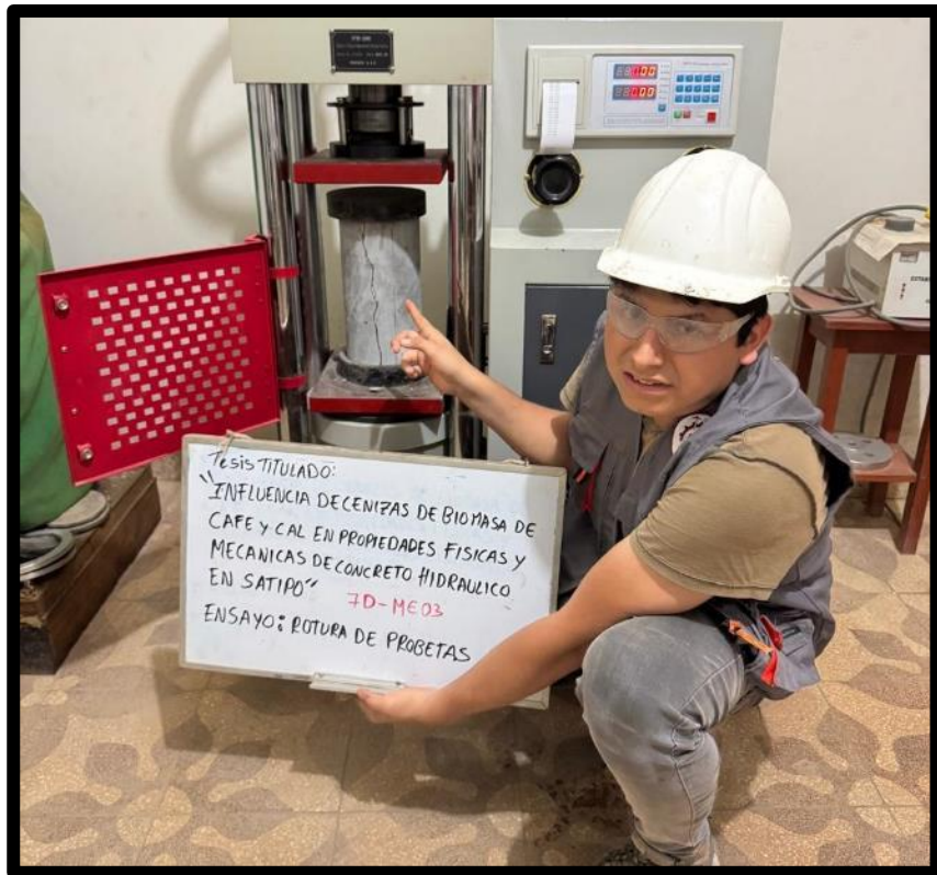
Foto 18: Rotura de probetas de concreto.
