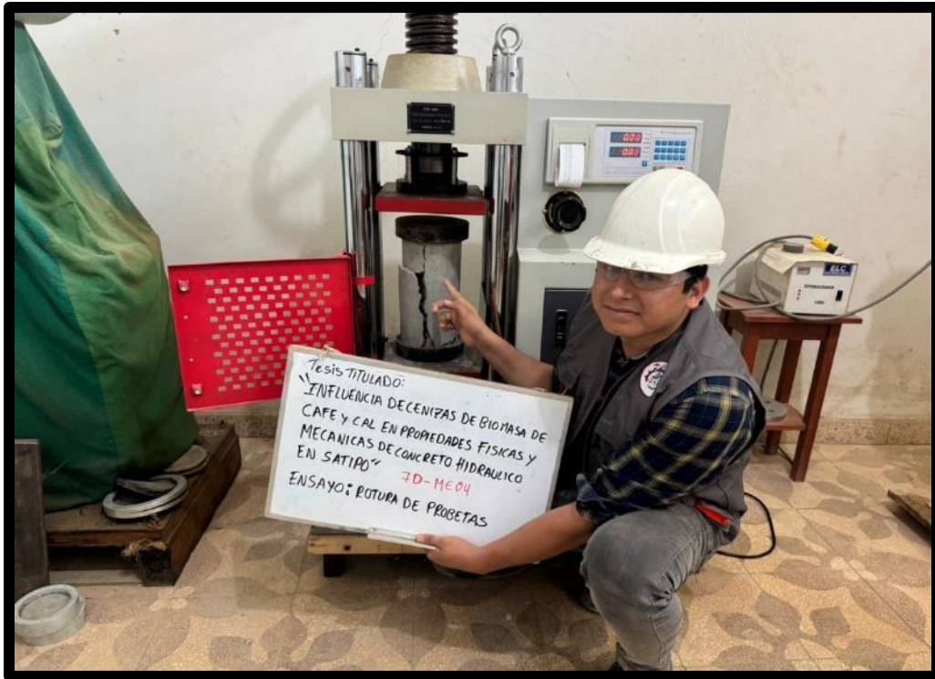
Foto 17: Rotura de probetas de concreto.
