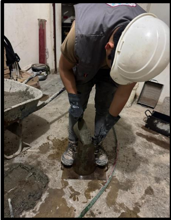
Foto 9: Realización de la prueba de SLUMB.
