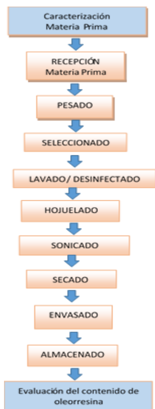
Figura 2. Proceso de deshidratado del jengibre con pretratamiento ultrasónico
