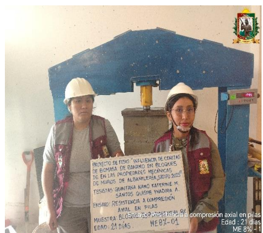
FOTO N° 107: Ensayo de resistencia a la compresión axial en pilas de 2 hileras, edad de 21 días de la ME 8% - 01.
