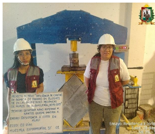
FOTO N° 160: Ensayo de resistencia al corte en muretes de la ME 3% - 01.
