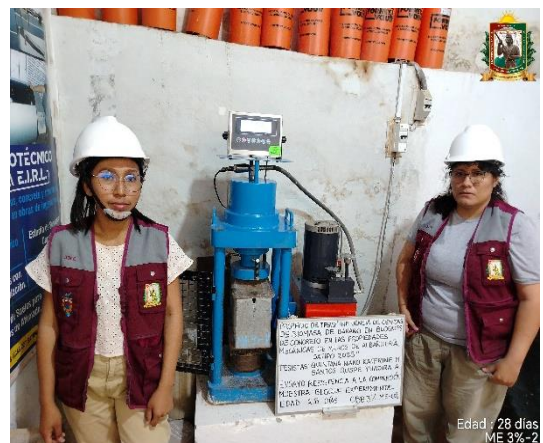
FOTO N° 57: Ensayo de resistencia a la compresión en unidad de albañilería edad 28 días de la ME 3% - 02.
