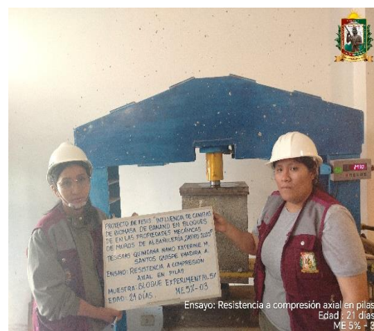
FOTO N° 106: Ensayo de resistencia a la compresión axial en pilas de 2 hileras, edad de 21 días de la ME 5% - 03.
