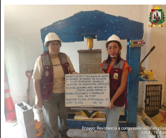
FOTO N° 74: Ensayo de resistencia a la compresión axial en pilas de 2 hileras, edad de 14 días de la ME 5% - 01.
