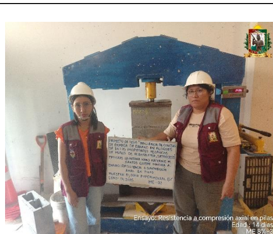
FOTO N° 79: Ensayo de resistencia a la compresión axial en pilas de 2 hileras, edad de 14 días de la ME 8% - 03.
