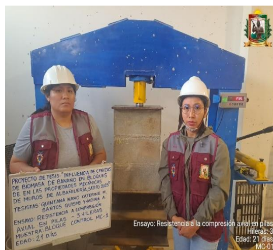
FOTO N° 113: Ensayo de resistencia a la compresión axial en pilas de 3 hileras, edad de 21 días de la MC - 01.
