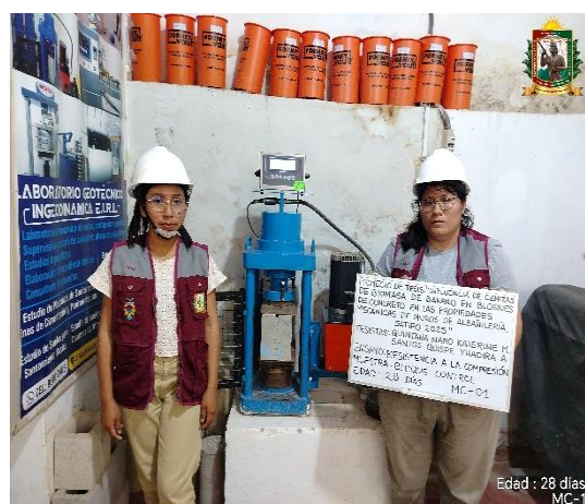
FOTO N° 53: Ensayo de resistencia a la compresión en unidad de albañilería edad 28 días de la MC - 01.
