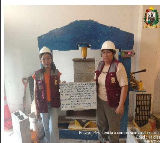
FOTO N° 76: Ensayo de resistencia a la compresión axial en pilas de 2 hileras, edad de 14 días de la ME 5% - 03.
