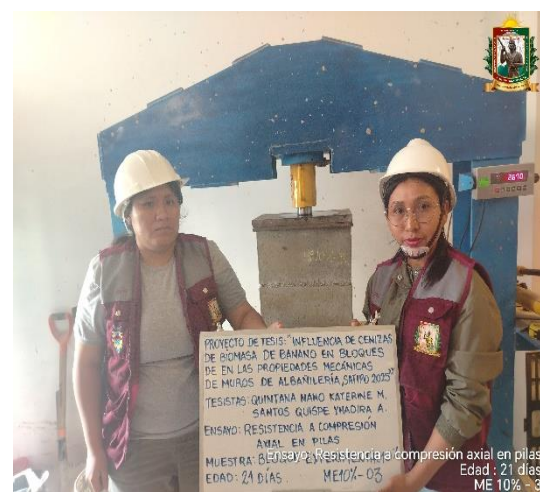
FOTO N° 112: Ensayo de resistencia a la compresión axial en pilas de 2 hileras, edad de 21 días de la ME 10% - 03.
