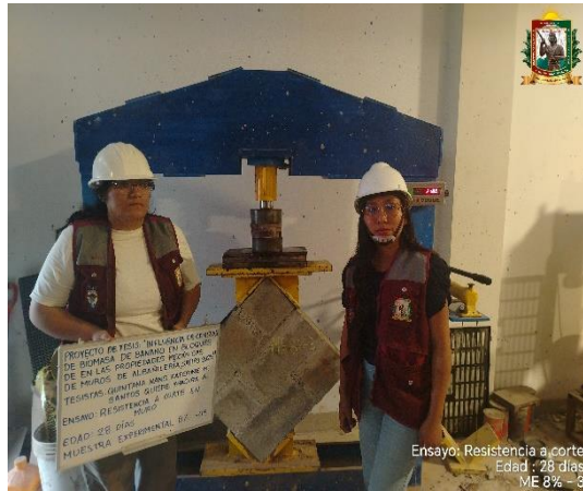
FOTO N° 162: Ensayo de resistencia al corte en muretes de la ME 8% - 01.
