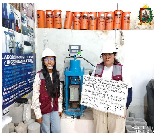
FOTO N° 52: Ensayo de resistencia a la compresión en unidad de albañilería edad 14 días de la ME 10% - 03.
