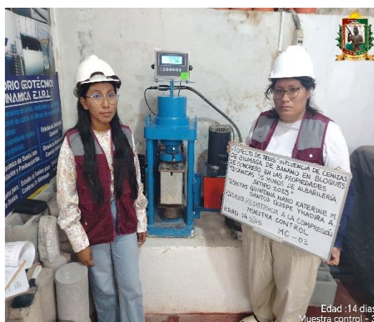
FOTO N° 41: Ensayo de resistencia a la compresión en unidad de albañilería edad 14 días de la MC - 03.
