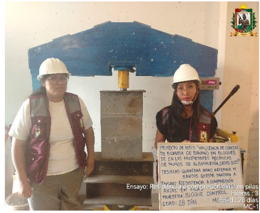
FOTO N° 137: Ensayo de resistencia a la compresión axial en pilas de 3 hileras, edad de 28 días de la MC - 01.
