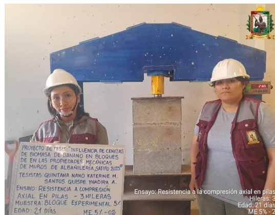
FOTO N° 114: Ensayo de resistencia a la compresión axial en pilas de 3 hileras, edad de 21 días de la ME 5% - 02.
