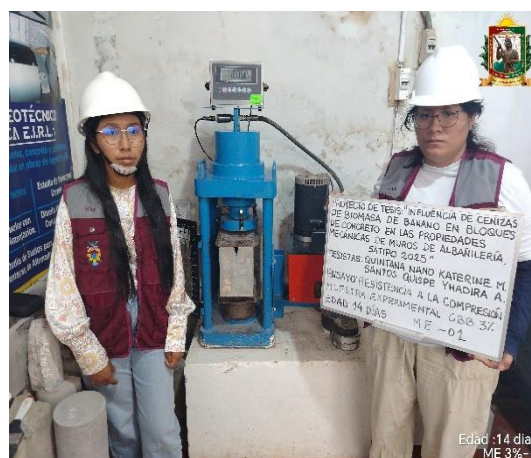
FOTO N° 42: Ensayo de resistencia a la compresión en unidad de albañilería edad 14 días de la ME 3% - 01.
