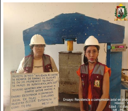
FOTO N° 86: Ensayo de resistencia a la compresión axial en pilas de 3 hileras, edad de 14 días de la ME 3% - 01.
