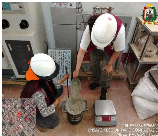
FOTO N° 13: Ensayo del peso unitario compactado del confítillo.
