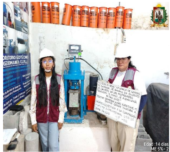
FOTO N° 45: Ensayo de resistencia a la compresión en unidad de albañilería edad 14 días de la ME 5% - 02.
