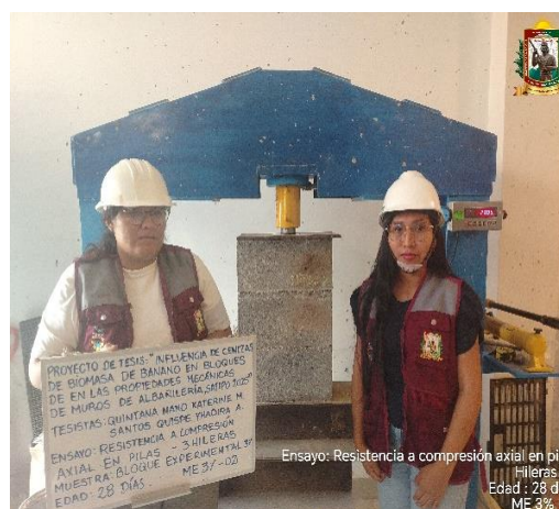
FOTO N° 141: Ensayo de resistencia a la compresión axial en pilas de 3 hileras, edad de 28 días de la ME 3% - 02.
