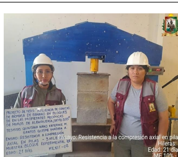
FOTO N° 120: Ensayo de resistencia a la compresión axial en pilas de 3 hileras, edad de 21 días de la ME 10% - 02.
