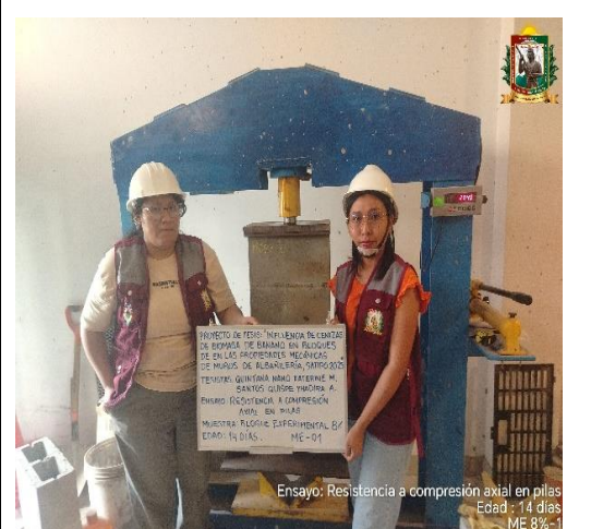
FOTO N° 77: Ensayo de resistencia a la compresión axial en pilas de 2 hileras, edad de 14 días de la ME 8% - 01.
