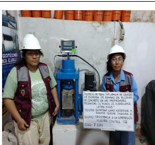
FOTO N° 25: Ensayo de resistencia a la compresión en unidad de albañilería edad 7 días de la MC- 02.
