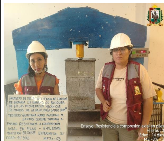
FOTO N° 88: Ensayo de resistencia a la compresión axial en pilas de 3 hileras, edad de 14 días de la ME 3% - 03.
