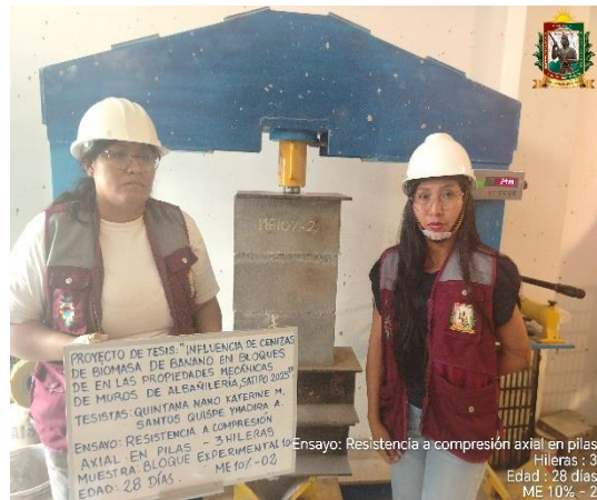
FOTO N° 150: Ensayo de resistencia a la compresión axial en pilas de 3 hileras, edad de 28 días de la ME 10% - 02.
