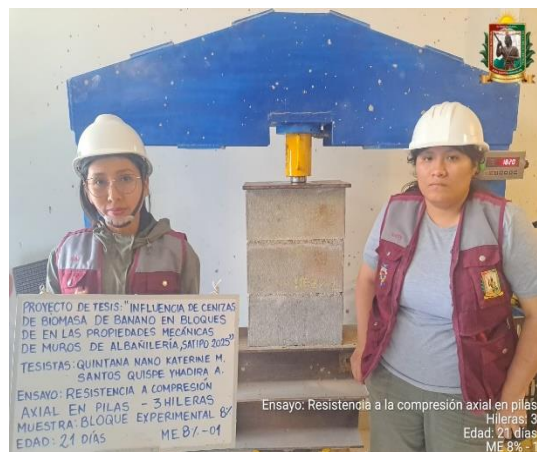
FOTO N° 116: Ensayo de resistencia a la compresión axial en pilas de 3 hileras, edad de 21 días de la ME 8% - 01.
