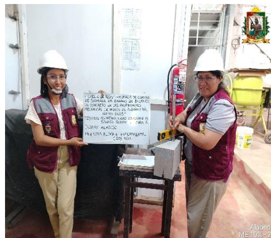
FOTO N° 22: Ensayo de alabeo.
