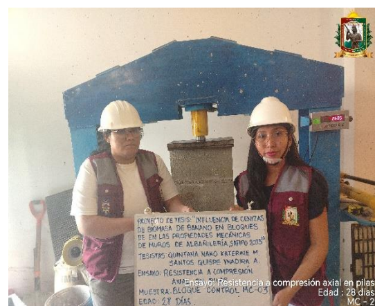
FOTO N° 124: Ensayo de resistencia a la compresión axial en pilas de 2 hileras, edad de 28 días de la MC - 03.
