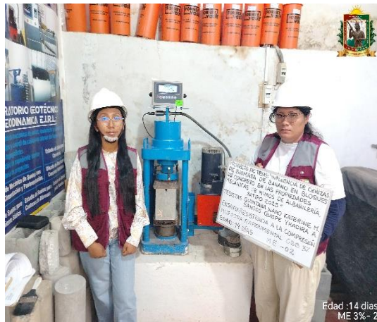
FOTO N° 43: Ensayo de resistencia a la compresión en unidad de albañilería edad 14 días de la ME 3% - 02.
