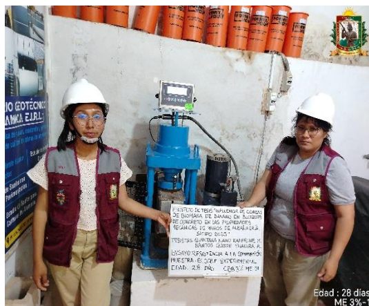
FOTO N° 56: Ensayo de resistencia a la compresión en unidad de albañilería edad 28 días de la ME 3% - 01.
