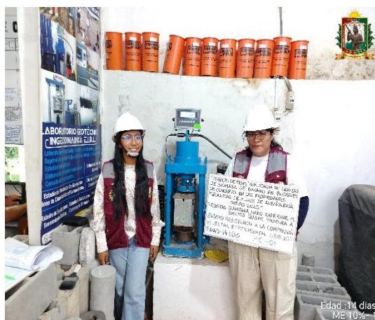
FOTO N° 50: Ensayo de resistencia a la compresión en unidad de albañilería edad 14 días de la ME 10% - 01.
