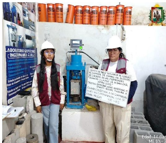
FOTO N° 48: Ensayo de resistencia a la compresión en unidad de albañilería edad 14 días de la ME 8% - 02.
