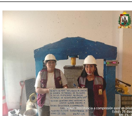
FOTO N° 127: Ensayo de resistencia a la compresión axial en pilas de 2 hileras, edad de 28 días de la ME 3% - 03.
