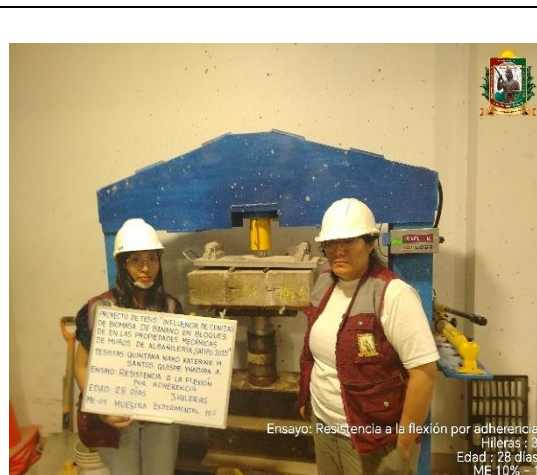
FOTO N° 156: Ensayo de resistencia a la flexión por adherencia en pilas de la ME 10% - 01.
