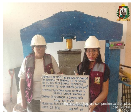
FOTO N° 134: Ensayo de resistencia a la compresión axial en pilas de 2 hileras, edad de 28 días de la ME 10% - 01.
