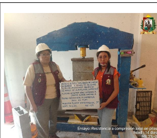
FOTO N° 73: Ensayo de resistencia a la compresión axial en pilas de 2 hileras, edad de 14 días de la ME 3% - 03.
