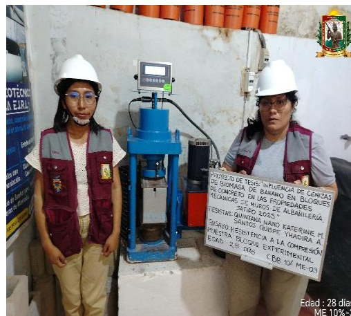
FOTO N° 67: Ensayo de resistencia a la compresión en unidad de albañilería edad 28 días de la ME 10% - 03.
