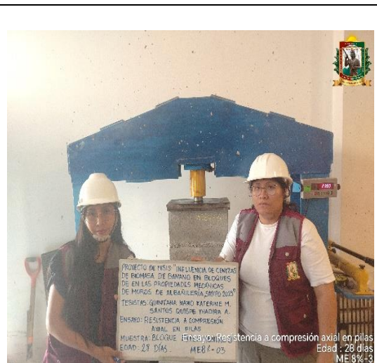
FOTO N° 133: Ensayo de resistencia a la compresión axial en pilas de 2 hileras, edad de 28 días de la ME 8% - 03.
