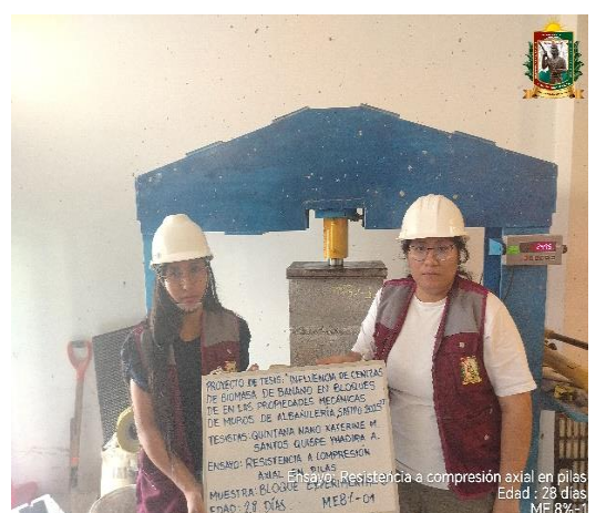
FOTO N° 131: Ensayo de resistencia a la compresión axial en pilas de 2 hileras, edad de 28 días de la ME 8% - 01.
