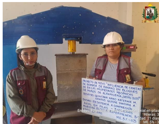
FOTO N° 115: Ensayo de resistencia a la compresión axial en pilas de 3 hileras, edad de 21 días de la ME 5% - 03.
