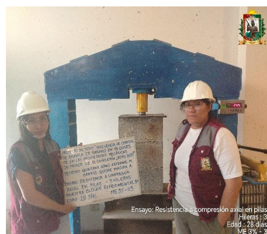
FOTO N° 142: Ensayo de resistencia a la compresión axial en pilas de 3 hileras, edad de 28 días de la ME 3% - 03.
