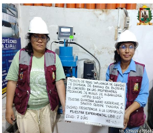
FOTO N° 35: Ensayo de resistencia a la compresión en unidad de albañilería edad 7 días de la ME 8% - 03.
