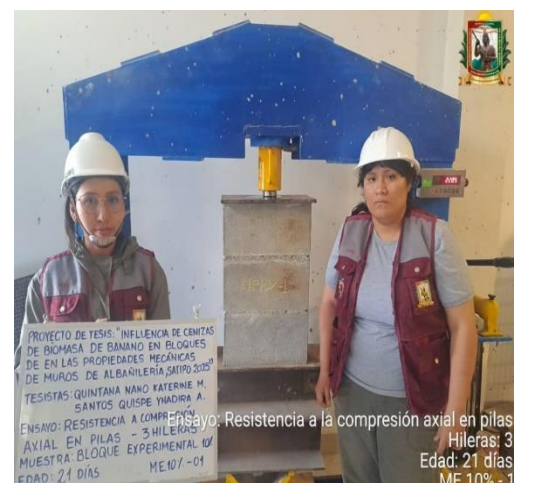
FOTO N° 119: Ensayo de resistencia a la compresión axial en pilas de 3 hileras, edad de 21 días de la ME 10% - 01.
