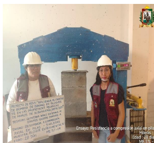
FOTO N° 143: Ensayo de resistencia a la compresión axial en pilas de 3 hileras, edad de 28 días de la ME 5% - 01.
