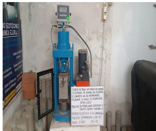
FOTO N° 38: Ensayo de resistencia a la compresión en unidad de albañilería edad 7 días de la ME 10% - 03.
