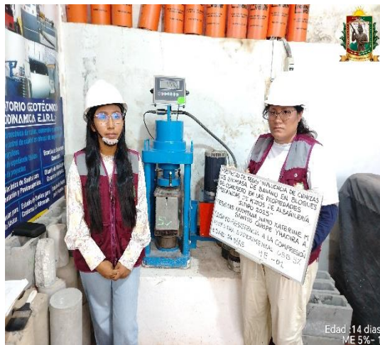
FOTO N° 45: Ensayo de resistencia a la compresión en unidad de albañilería edad 14 días de la ME 5% - 01.
