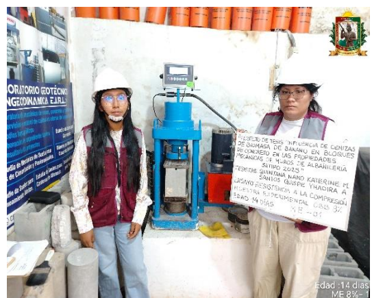
FOTO N° 47: Ensayo de resistencia a la compresión en unidad de albañilería edad 14 días de la ME 8% - 01.
