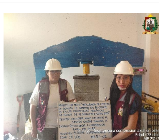
FOTO N° 126: Ensayo de resistencia a la compresión axial en pilas de 2 hileras, edad de 28 días de la ME 3% - 02.
