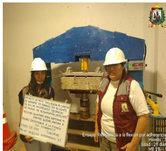
FOTO N° 154: Ensayo de resistencia a la flexión por adherencia en pilas de la ME 5% - 01.
