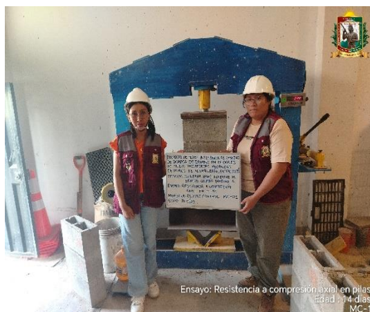
FOTO N° 68: Ensayo de resistencia a la compresión axial en pilas de 2 hileras, edad de 14 días de la MC – 01.
