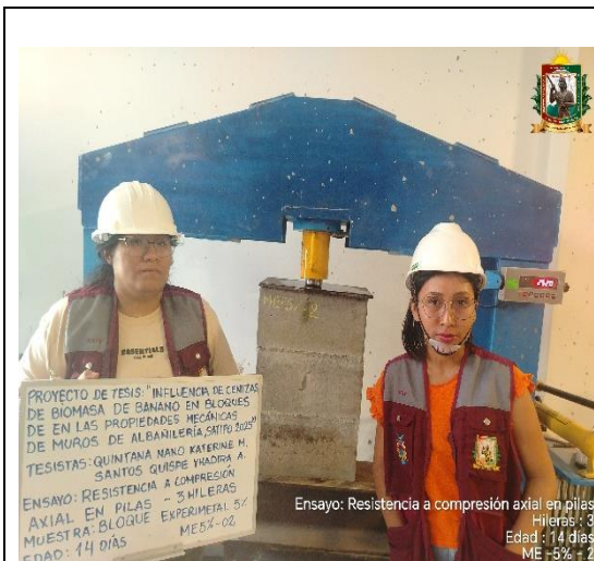
FOTO N° 90: Ensayo de resistencia a la compresión axial en pilas de 3 hileras, edad de 14 días de la ME 5% - 02.
