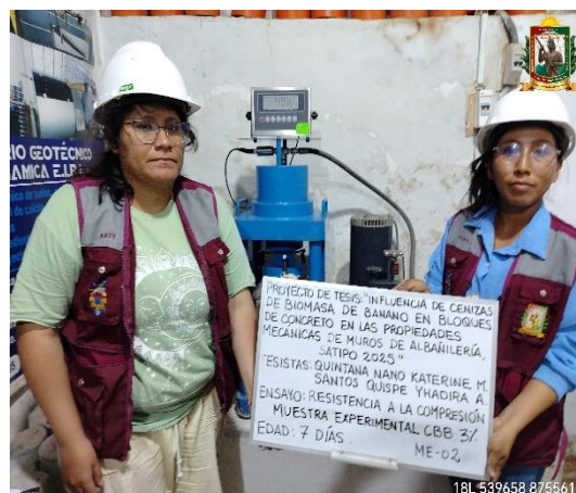
FOTO N° 28: Ensayo de resistencia a la compresión en unidad de albañilería edad 7 días de la ME 3% - 02.
