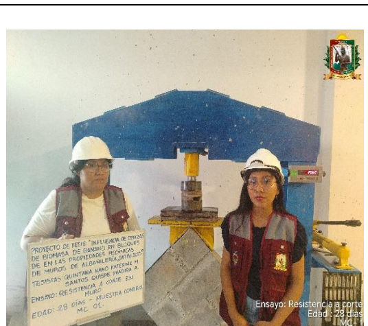
FOTO N° 157: Ensayo de resistencia al corte en muretes de la MC - 01.
