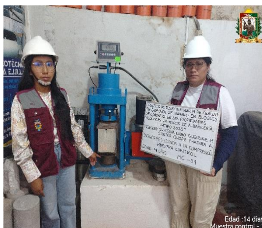
FOTO N° 39: Ensayo de resistencia a la compresión en unidad de albañilería edad 14 días de la MC - 01.
