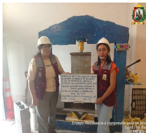
FOTO N° 71: Ensayo de resistencia a la compresión axial en pilas de 2 hileras, edad de 14 días de la ME 3% - 01.
