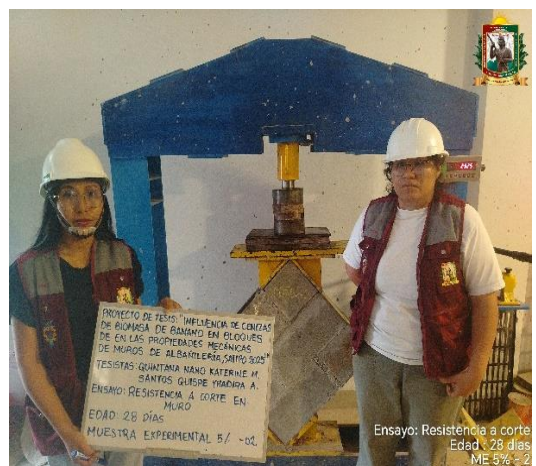
FOTO N° 161: Ensayo de resistencia al corte en muretes de la ME 5% - 01.
