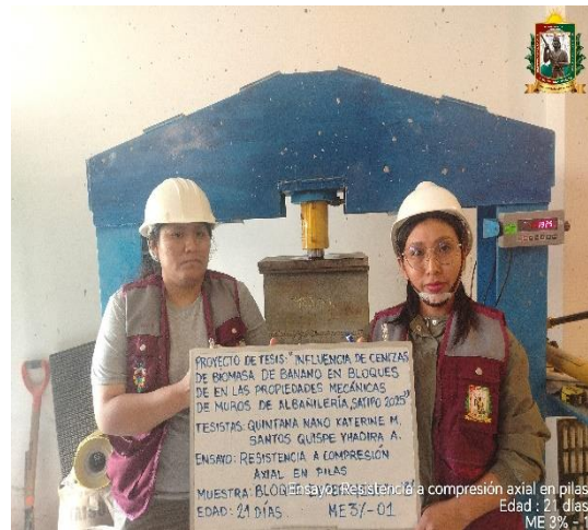
FOTO N° 101: Ensayo de resistencia a la compresión axial en pilas de 2 hileras, edad de 21 días de la ME 3% - 01.
