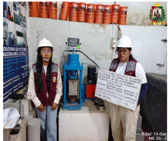
FOTO N° 44: Ensayo de resistencia a la compresión en unidad de albañilería edad 14 días de la ME 3% - 03.
