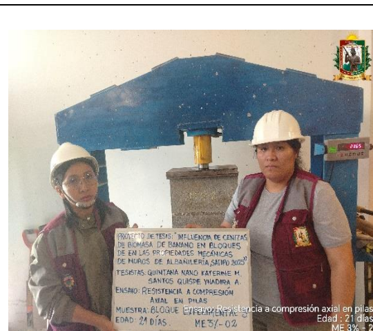
FOTO N° 102: Ensayo de resistencia a la compresión axial en pilas de 2 hileras, edad de 21 días de la ME 3% - 02.
