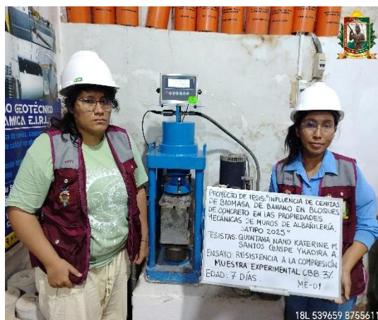
FOTO N° 27: Ensayo de resistencia a la compresión en unidad de albañilería edad 7 días de la ME 3% - 01.
