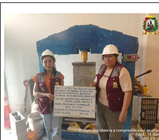
FOTO N° 72: Ensayo de resistencia a la compresión axial en pilas de 2 hileras, edad de 14 días de la ME 3% - 02.
