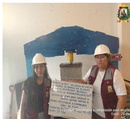
FOTO N° 123: Ensayo de resistencia a la compresión axial en pilas de 2 hileras, edad de 28 días de la MC - 02.
