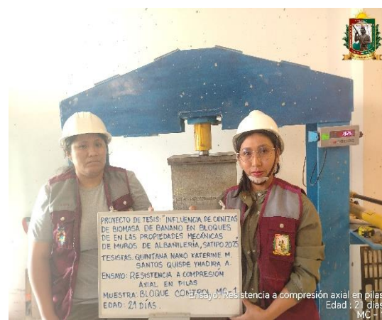
FOTO N° 98: Ensayo de resistencia a la compresión axial en pilas de 2 hileras, edad de 21 días de la MC - 01.
