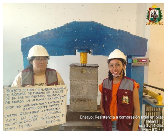
FOTO N° 93: Ensayo de resistencia a la compresión axial en pilas de 3 hileras, edad de 14 días de la ME 8% - 02.
