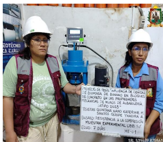
FOTO N° 30: Ensayo de resistencia a la compresión en unidad de albañilería edad 7 días de la ME 5% - 01.
