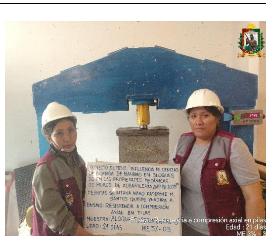
FOTO N° 103: Ensayo de resistencia a la compresión axial en pilas de 2 hileras, edad de 21 días de la ME 3% - 03.
