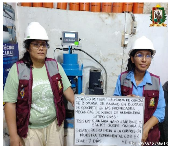
FOTO N° 34: Ensayo de resistencia a la compresión en unidad de albañilería edad 7 días de la ME 8% - 02.
