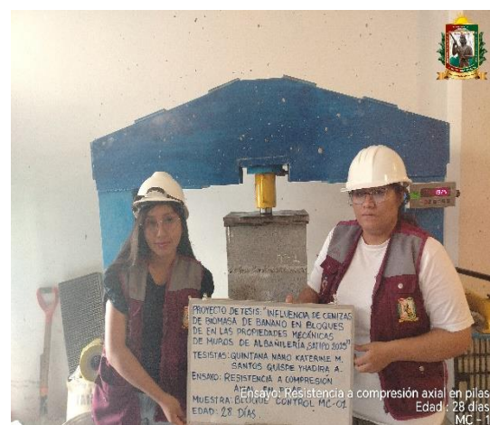
FOTO N° 122: Ensayo de resistencia a la compresión axial en pilas de 2 hileras, edad de 28 días de la MC - 01.
