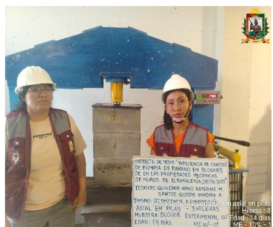
FOTO N° 95: Ensayo de resistencia a la compresión axial en pilas de 3 hileras, edad de 14 días de la ME 10% - 01.
