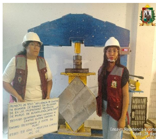
FOTO N° 158: Ensayo de resistencia al corte en muretes de la MC - 02.
