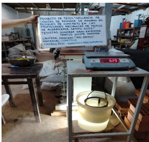
FOTO N° 15: Ensayo de gravedad específica y absorción del confítillo.
