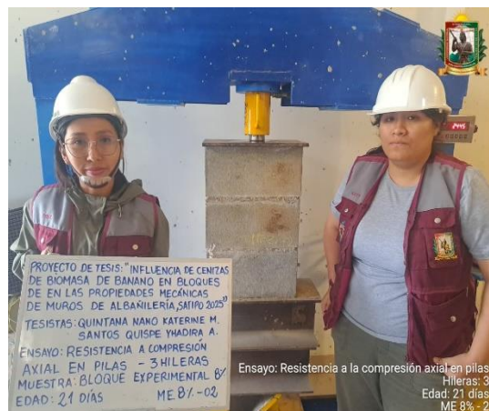
FOTO N° 117: Ensayo de resistencia a la compresión axial en pilas de 3 hileras, edad de 21 días de la ME 8% - 02.
