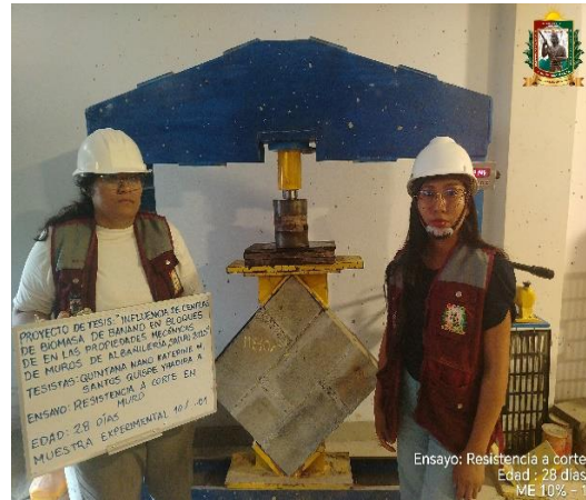
FOTO N° 163: Ensayo de resistencia al corte en muretes de la ME 10% - 01.
