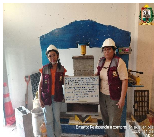
FOTO N° 69: Ensayo de resistencia a la compresión axial en pilas de 2 hileras, edad de 14 días de la MC – 02.
