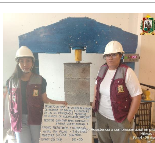
FOTO N° 139: Ensayo de resistencia a la compresión axial en pilas de 3 hileras, edad de 28 días de la MC - 03.
