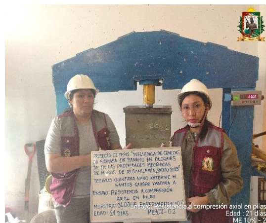
FOTO N° 111: Ensayo de resistencia a la compresión axial en pilas de 2 hileras, edad de 21 días de la ME 10% - 02.
