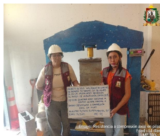
FOTO N° 80: Ensayo de resistencia a la compresión axial en pilas de 2 hileras, edad de 14 días de la ME 10% - 01.
