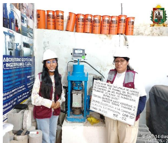
FOTO N° 51: Ensayo de resistencia a la compresión en unidad de albañilería edad 14 días de la ME 10% - 02.
