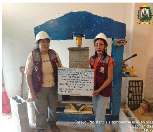
FOTO N° 70: Ensayo de resistencia a la compresión axial en pilas de 2 hileras, edad de 14 días de la MC – 03.
