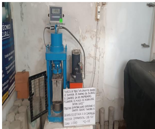
FOTO N° 37: Ensayo de resistencia a la compresión en unidad de albañilería edad 7 días de la ME 10% - 02.
