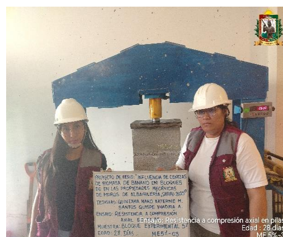
FOTO N° 130: Ensayo de resistencia a la compresión axial en pilas de 2 hileras, edad de 28 días de la ME 5% - 03.
