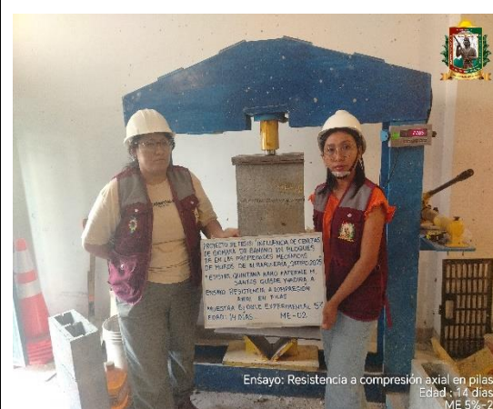
FOTO N° 75: Ensayo de resistencia a la compresión axial en pilas de 2 hileras, edad de 14 días de la ME 5% - 02.
