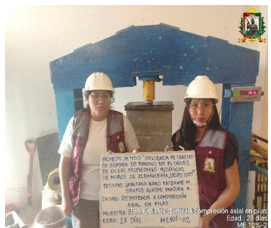
FOTO N° 135: Ensayo de resistencia a la compresión axial en pilas de 2 hileras, edad de 28 días de la ME 10% - 02.
