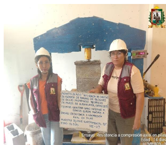
FOTO N° 82: Ensayo de resistencia a la compresión axial en pilas de 2 hileras, edad de 14 días de la ME 10% - 03.
