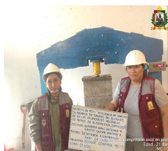
FOTO N° 100: Ensayo de resistencia a la compresión axial en pilas de 2 hileras, edad de 21 días de la MC - 03.
