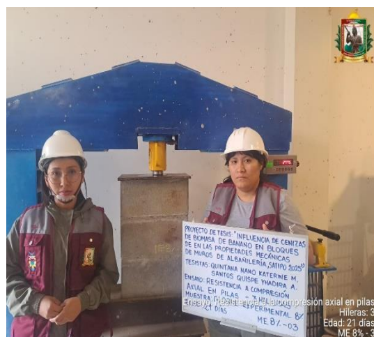
FOTO N° 118: Ensayo de resistencia a la compresión axial en pilas de 3 hileras, edad de 21 días de la ME 8% - 03.
