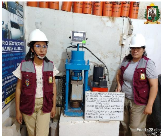
FOTO N° 54: Ensayo de resistencia a la compresión en unidad de albañilería edad 28 días de la MC -02.
