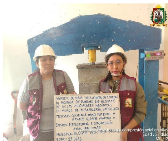
FOTO N° 99: Ensayo de resistencia a la compresión axial en pilas de 2 hileras, edad de 21 días de la MC - 02.
