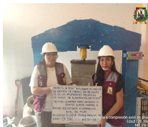
FOTO N° 125: Ensayo de resistencia a la compresión axial en pilas de 2 hileras, edad de 28 días de la ME 3% - 01.
