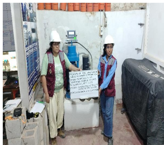
FOTO N° 26: Ensayo de resistencia a la compresión en unidad de albañilería edad 7 días de la MC- 03.
