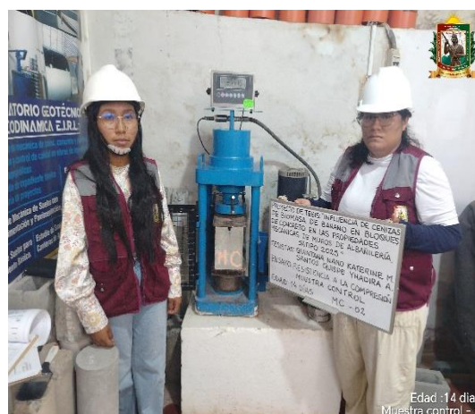
FOTO N° 40: Ensayo de resistencia a la compresión en unidad de albañilería edad 14 días de la MC - 02.
