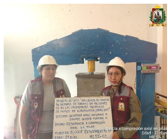
FOTO N° 104: Ensayo de resistencia a la compresión axial en pilas de 2 hileras, edad de 21 días de la ME 5% - 01.
