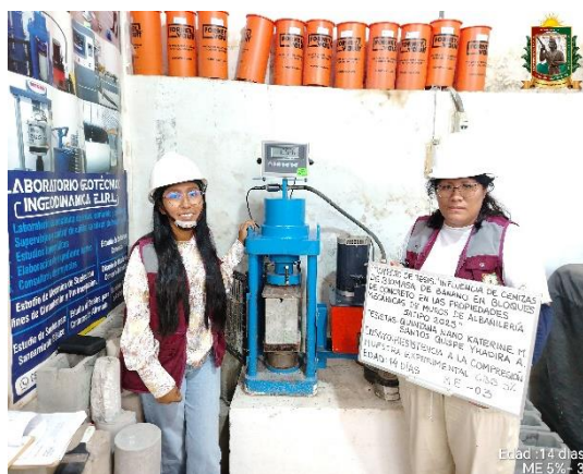
FOTO N° 46: Ensayo de resistencia a la compresión en unidad de albañilería edad 14 días de la ME 5% - 03.
