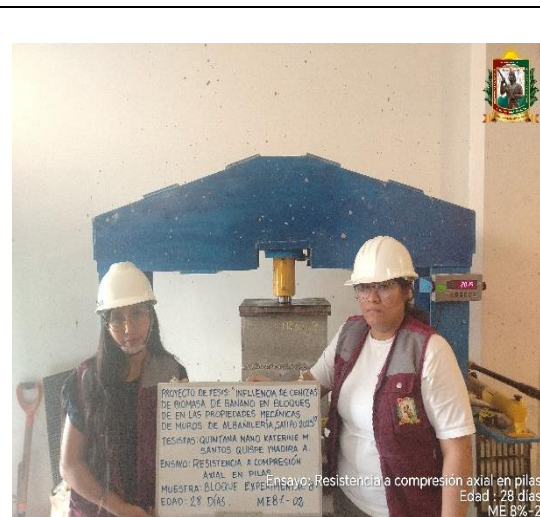
FOTO N° 132: Ensayo de resistencia a la compresión axial en pilas de 2 hileras, edad de 28 días de la ME 8% - 02.
