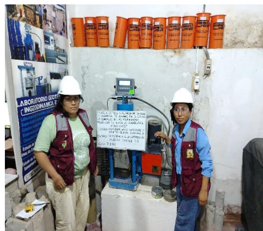
FOTO N° 24: Ensayo de resistencia a la compresión en unidad de albañilería edad 7 días de la MC- 01.
