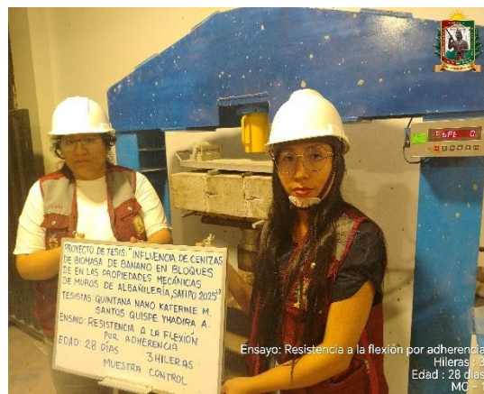
FOTO N° 152: Ensayo de resistencia a la flexión por adherencia en pilas de la MC - 01.
