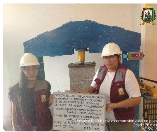
FOTO N° 129: Ensayo de resistencia a la compresión axial en pilas de 2 hileras, edad de 28 días de la ME 5% - 02.
