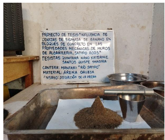
FOTO N° 16: Ensayo de gravedad específica y absorción de la arena gruesa.
