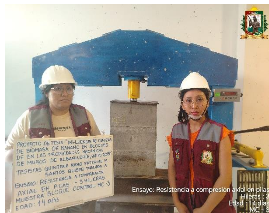
FOTO N° 85: Ensayo de resistencia a la compresión axial en pilas de 3 hileras, edad de 14 días de la MC - 03.
