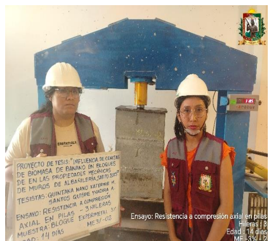
FOTO N° 87: Ensayo de resistencia a la compresión axial en pilas de 3 hileras, edad de 14 días de la ME 3% - 02.
