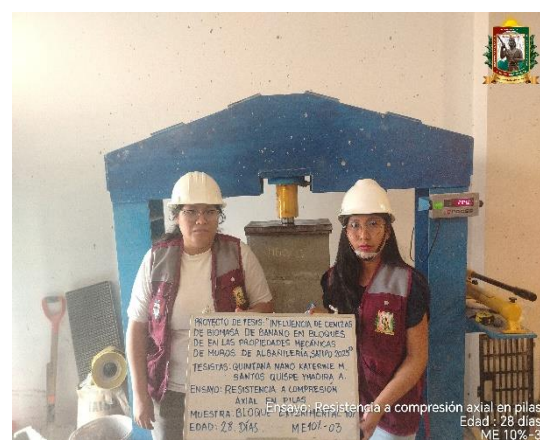
FOTO N° 136: Ensayo de resistencia a la compresión axial en pilas de 2 hileras, edad de 28 días de la ME 10% - 03.
