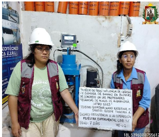
FOTO N° 31: Ensayo de resistencia a la compresión en unidad de albañilería edad 7 días de la ME 5% - 02.
