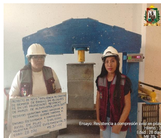
FOTO N° 140: Ensayo de resistencia a la compresión axial en pilas de 3 hileras, edad de 28 días de la ME 3% - 01.
