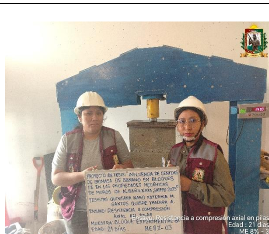
FOTO N° 109: Ensayo de resistencia a la compresión axial en pilas de 2 hileras, edad de 21 días de la ME 8% - 03.
