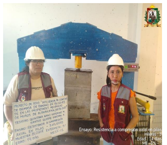
FOTO N° 89: Ensayo de resistencia a la compresión axial en pilas de 3 hileras, edad de 14 días de la ME 5% - 01.
