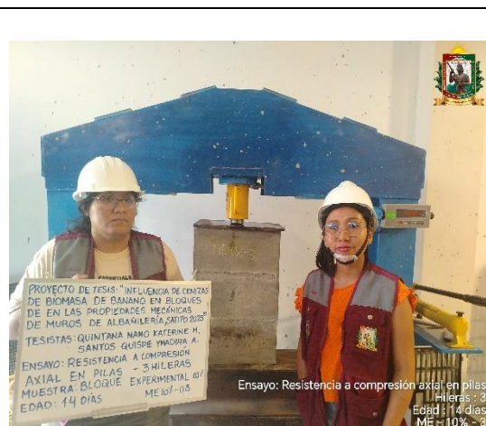
FOTO N° 97: Ensayo de resistencia a la compresión axial en pilas de 3 hileras, edad de 14 días de la ME 10% - 03.
