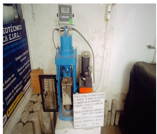
FOTO N° 36: Ensayo de resistencia a la compresión en unidad de albañilería edad 7 días de la ME 10% - 01.
