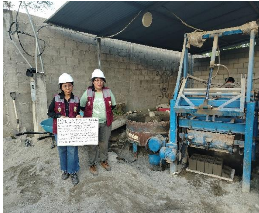
FOTO N° 19: Elaboración de los bloques de concreto.
