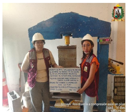
FOTO N° 81: Ensayo de resistencia a la compresión axial en pilas de 2 hileras, edad de 14 días de la ME 10% - 02.
