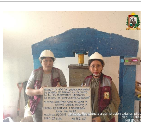
FOTO N° 108: Ensayo de resistencia a la compresión axial en pilas de 2 hileras, edad de 21 días de la ME 8% - 02.
