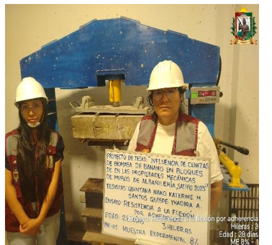
FOTO N° 155: Ensayo de resistencia a la flexión por adherencia en pilas de la ME 8% - 01.
