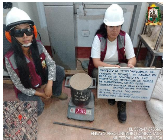
FOTO N° 14: Ensayo del peso unitario compactado de la arena gruesa.
