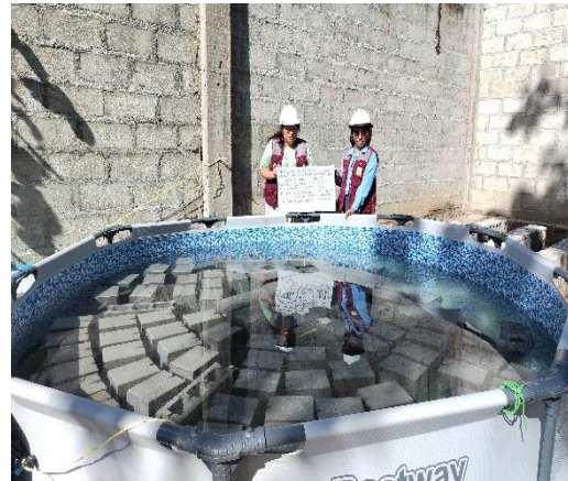
FOTO N° 20: Curado de los bloques de concreto.
