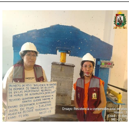
FOTO N° 91: Ensayo de resistencia a la compresión axial en pilas de 3 hileras, edad de 14 días de la ME 5% - 03.
