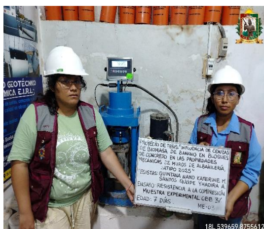
FOTO N° 29: Ensayo de resistencia a la compresión en unidad de albañilería edad 7 días de la ME 3% - 03.
