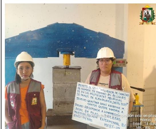
FOTO N° 94: Ensayo de resistencia a la compresión axial en pilas de 3 hileras, edad de 14 días de la ME 8% - 03.
