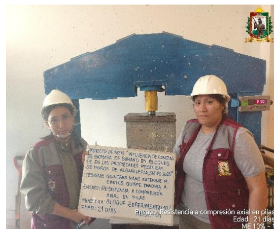
FOTO N° 110: Ensayo de resistencia a la compresión axial en pilas de 2 hileras, edad de 21 días de la ME 10% - 01.
