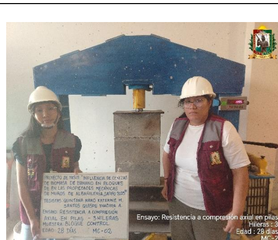
FOTO N° 138: Ensayo de resistencia a la compresión axial en pilas de 3 hileras, edad de 28 días de la MC - 02.
