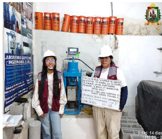
FOTO N° 49: Ensayo de resistencia a la compresión en unidad de albañilería edad 14 días de la ME 8% - 03.
