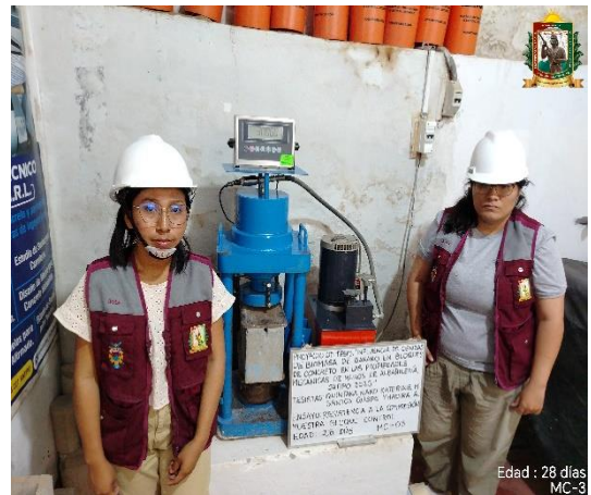
FOTO N° 55: Ensayo de resistencia a la compresión en unidad de albañilería edad 28 días de la MC -03.
