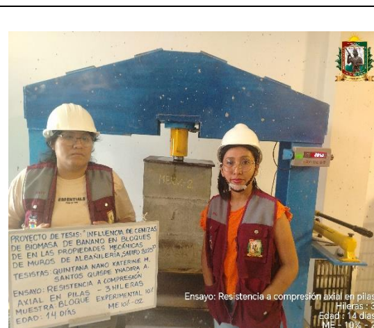
FOTO N° 96: Ensayo de resistencia a la compresión axial en pilas de 3 hileras, edad de 14 días de la ME 10% - 02.
