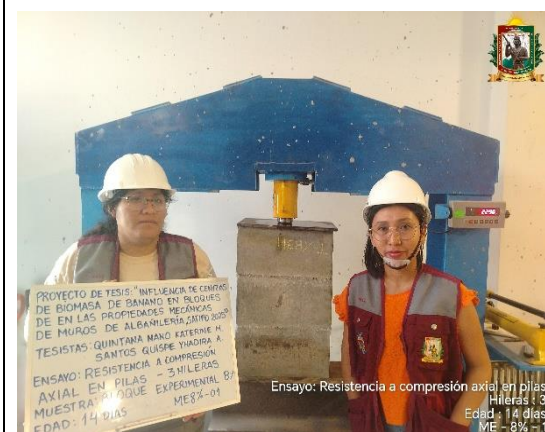
FOTO N° 92: Ensayo de resistencia a la compresión axial en pilas de 3 hileras, edad de 14 días de la ME 8% - 01.
