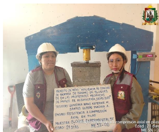
FOTO N° 105: Ensayo de resistencia a la compresión axial en pilas de 2 hileras, edad de 21 días de la ME 5% - 02.
