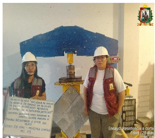
FOTO N° 159: Ensayo de resistencia al corte en muretes de la MC - 03.
