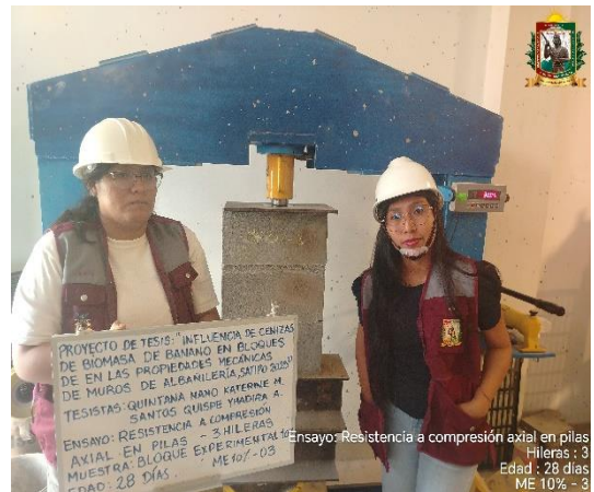
FOTO N° 151: Ensayo de resistencia a la compresión axial en pilas de 3 hileras, edad de 28 días de la ME 10% - 03.
