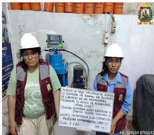
FOTO N° 33: Ensayo de resistencia a la compresión en unidad de albañilería edad 7 días de la ME 8% - 01.
