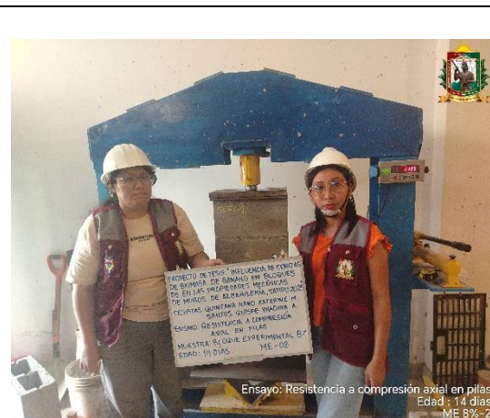
FOTO N° 78: Ensayo de resistencia a la compresión axial en pilas de 2 hileras, edad de 14 días de la ME 8% - 02.
