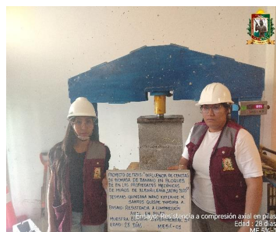
FOTO N° 128: Ensayo de resistencia a la compresión axial en pilas de 2 hileras, edad de 28 días de la ME 5% - 01.
