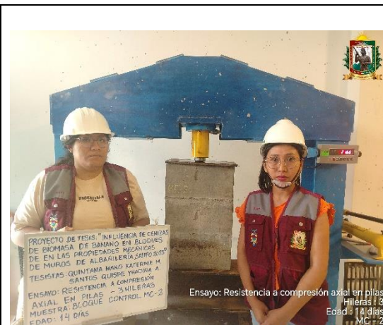
FOTO N° 84: Ensayo de resistencia a la compresión axial en pilas de 3 hileras, edad de 14 días de la MC - 02.
