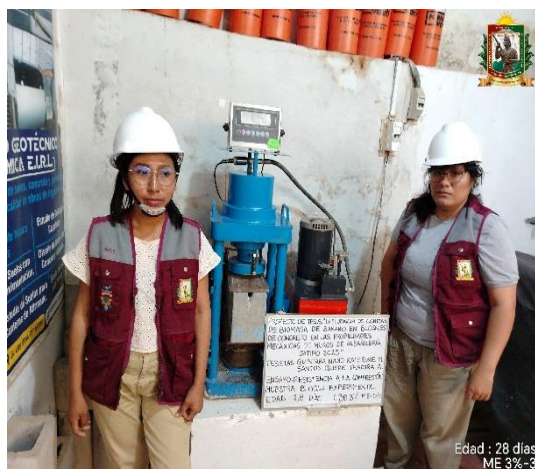
FOTO N° 58: Ensayo de resistencia a la compresión en unidad de albañilería edad 28 días de la ME 3% - 03.
