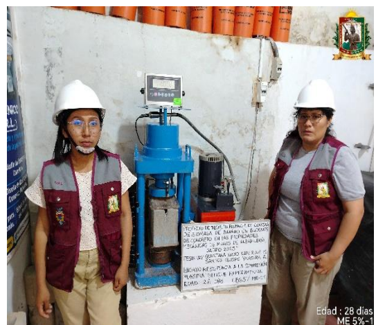
FOTO N° 59: Ensayo de resistencia a la compresión en unidad de albañilería edad 28 días de la ME 5% - 01.
