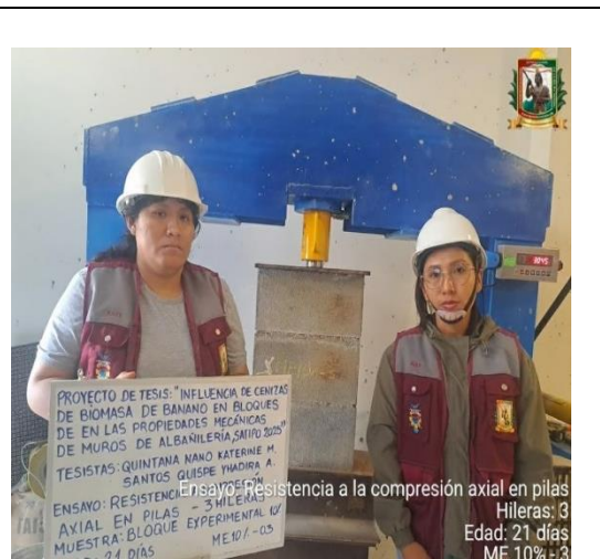
FOTO N° 121: Ensayo de resistencia a la compresión axial en pilas de 3 hileras, edad de 21 días de la ME 10% - 03.
