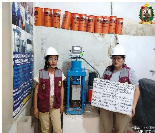
FOTO N° 66: Ensayo de resistencia a la compresión en unidad de albañilería edad 28 días de la ME 10% - 02.
