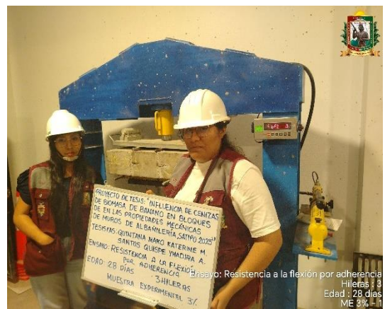
FOTO N° 153: Ensayo de resistencia a la flexión por adherencia en pilas de la ME 3% - 01.
