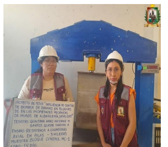
FOTO N° 83: Ensayo de resistencia a la compresión axial en pilas de 3 hileras, edad de 14 días de la MC - 01.
